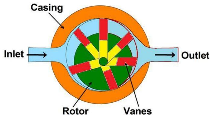
Fig. 5.3.5 Vane motor
